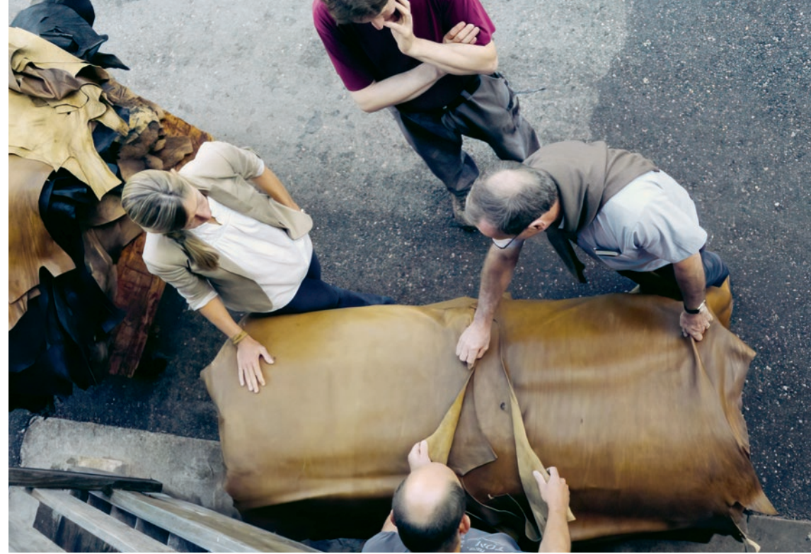
Für die Hirschlederbänder von Oris lässt Cervo Volante das Leder durch die letzten beiden Schweizer Gerbereien verarbeiten. Gerberbt wird zu 100 % pflanzlich – ohne Chrom und ohne synthetische Vorgerbung.
