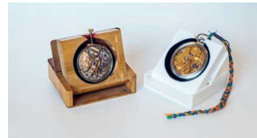
Die traditionelle Vorlage der Schatulle und der Prototyp aus dem 3-D-Drucker.
